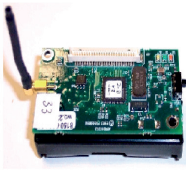
Figure 3.| Nœud capteur Berkeley [BREANNE et MALAN, 2004 ; CROSSBOW TECHNOLOGY INC.]
