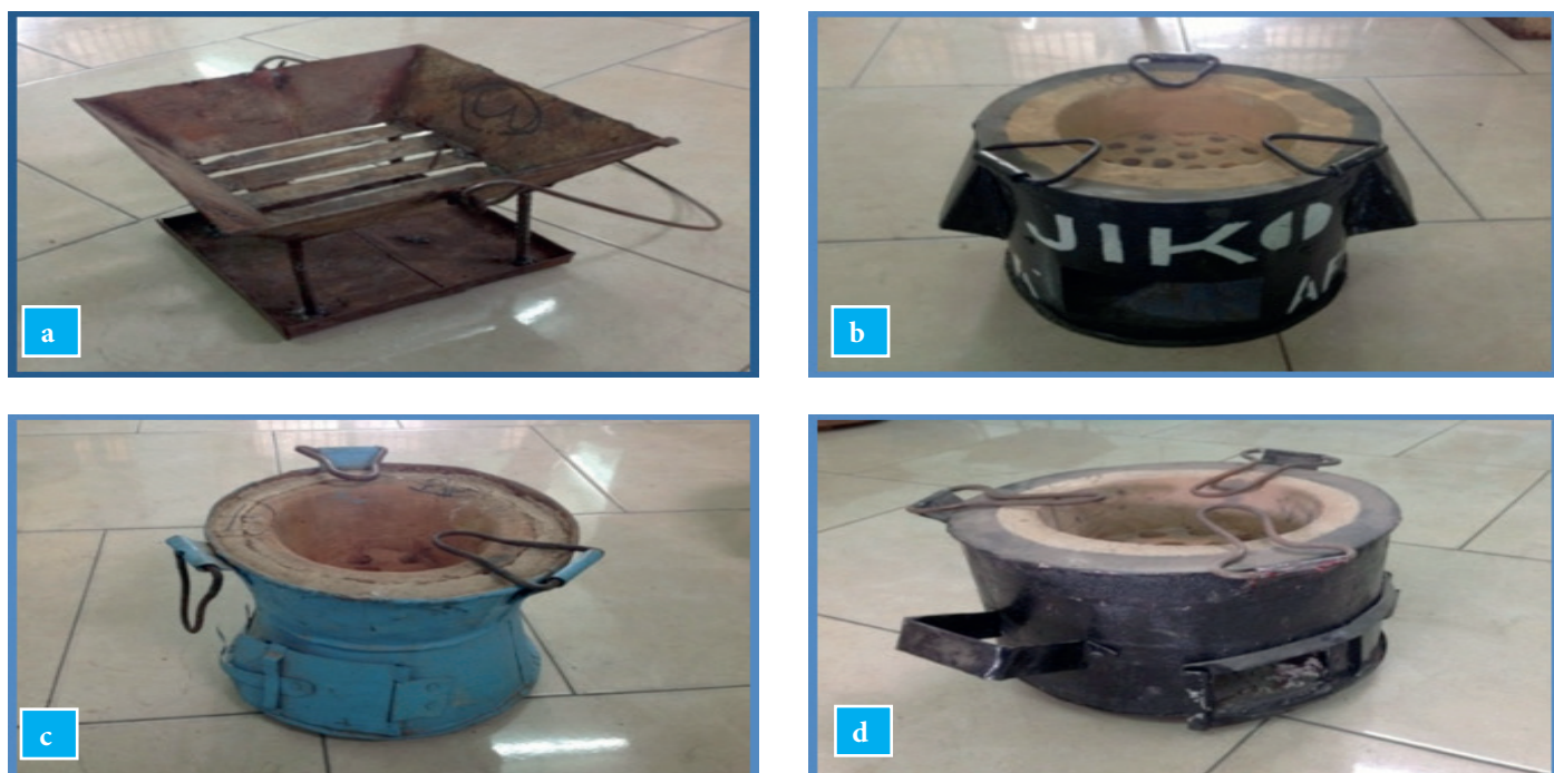
Figure 3| Les foyers de cuisson du Katanga testés au CERERK-ISTA Kinshasa: (a) Traditionnel de Lubumbashi; (b) JIKO MAMA AFRICA; (c) JIKO AD VV; (d) HALT BANK
