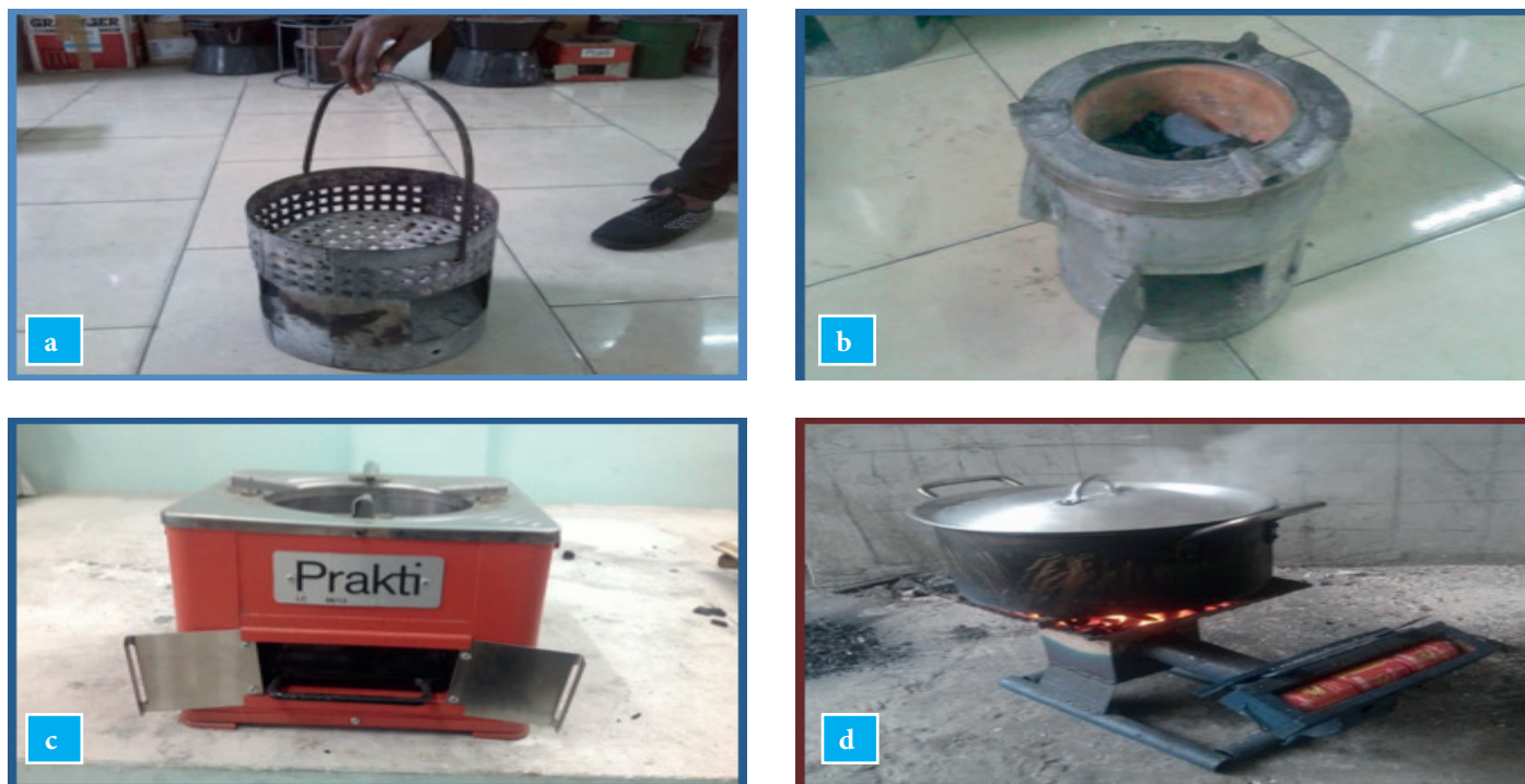
Figure 2| Les foyers de cuisson de Kinshasa testés au CERERK-ISTA Kinshasa: (a) Traditionnel de Kin; (b) Foyer KINSTOVE (PPN); (c) Foyer PRAKTI LC 06/13; (d) Foyer à piles.
