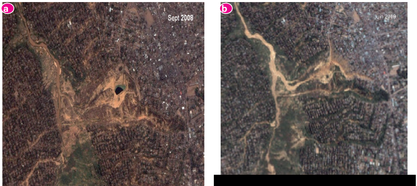
Figure 9| (a) Début saison des pluies : situation stable + caniveau (Image 2008 sur Google Earth 2010); (b) En plein saison sèche et donc situation héritée de la saison des pluies : stade de réactivité en suivant le profil du caniveau-Entretiens stabilité à la tête du ravin grâce à la déviation des eaux (Image 2009 sur Google Earth 2010)
